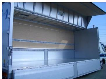
4トン車、5トン車で、**荷台長が7200mm**ありますので、長尺物が積めます。
