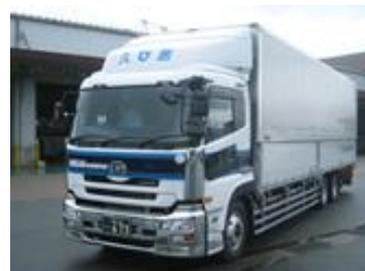
**増トン低床ウイング、エアサス車**で荷崩れ防止しています。
