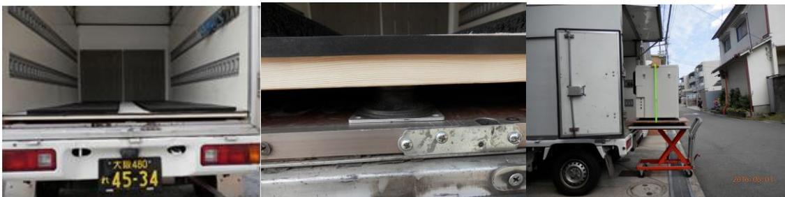
防振架台装備、荷台下9個のエアードンパー、上部20mmのウレタンを装備しておりますので、サーバー等振動に弱い荷物も大丈夫です。荷台寸法：奥行1m75cm、横幅1m30cm、高さ 1m46cm
